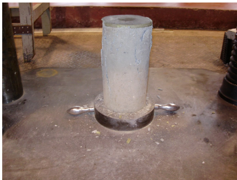
รูปที่ 7 แท่งตัวอย่างรูปทรงกระบอกที่ทดสอบบีบอัด
