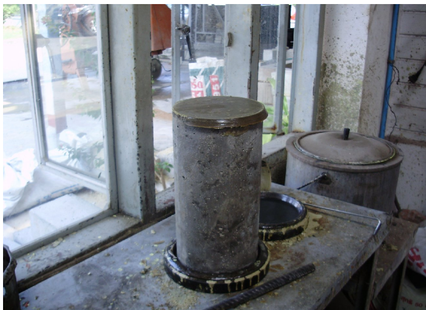
รูปที่ 3 การเคลือบผิวหน้าแท่งตัวอย่างรูปทรงกระบอกด้วยก้ำมะถันหลอมเหลว
